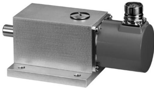
Bei Antrieb des Drehgebers über Zahn- oder Kettenrad, Keil- oder Zahnriemen, Laufrad usw., werden im Betrieb die zulässigen axialen oder radialen Wellenbelastungen zumeist überschritten.
