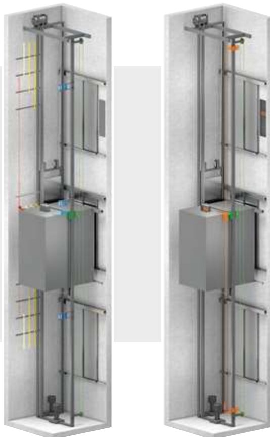
Konventionelle Schachtinstallation (links), Installation mit Kübler Schachtkopiersystem / Conventional shaft installation (left), installation with Kübler shaft copying system
