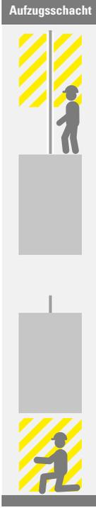
Beim Betreten des Schachtes mit reduziertem Schachtkopf/-grube gemäß EN 81-21 wird über die Türentriegelung der **Shield Modus Wartung** aktiviert. Ein Schutzraum, der ein sicheres Arbeiten für das Wartungspersonal ermöglicht, wird hergestellt.
