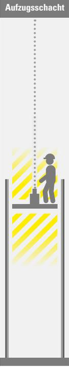
**Der Shield Modus Montage** gewährleistet einen Schutzraum für das Personal bereits vor der Inbetriebnahme des Aufzugs. Bei der Montage, wie beispielsweise der Schienenbefestigung, wird sequenziell ein Schutzraum entsprechend des Montagefortschritts hergestellt. Positionsabhängig wird die Kabine mit einer Toleranz von  $\pm 5$  cm gesichert.
