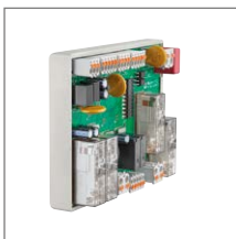
Kübler Auswerteeinheit PSU02 (im Schaltschrank)
