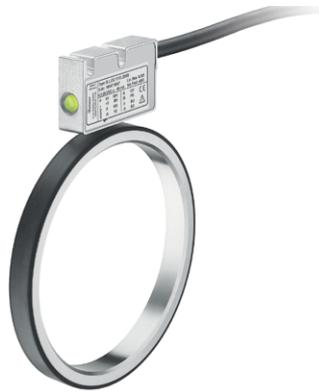
Der lagerlose Drehgeber RLI200, bestehend aus Magnetring und Sensorkopf, ist mit seiner Einbautiefe von min. 10 mm bestens geeignet für beengte Installationsmöglichkeiten. Das berührungslose Messprinzip ermöglicht einen fehlerfreien Einsatz auch unter widrigen Umgebungsbedingungen und eine lange Lebensdauer.
