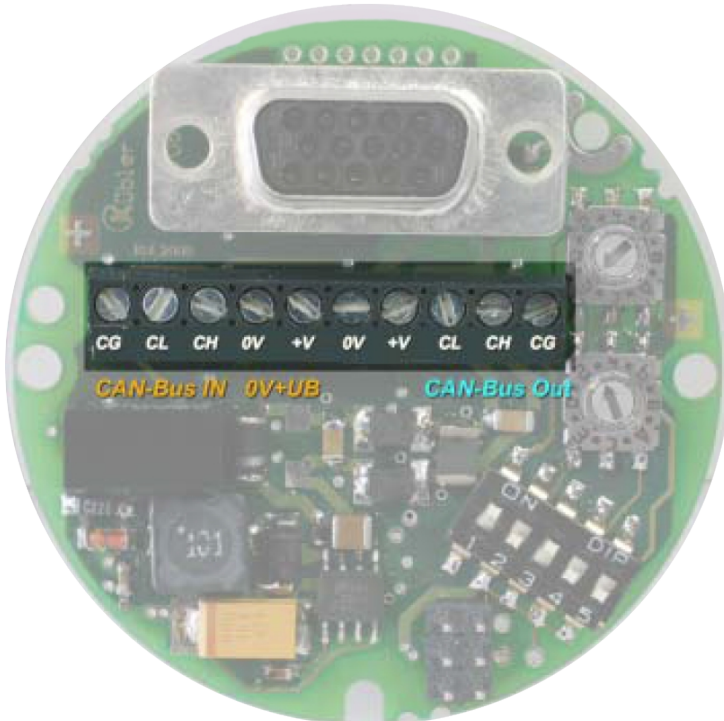
Ansicht in die geöffnete Bushaube / View into the open bus cover
