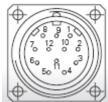
Anschlußbild M23-Stecker und Kabelabgang
