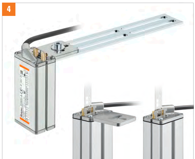
4 Maximale Flexibilität: Sensor mit Kabinenbefestigung verbinden und optimal justieren (drei mögliche Montagearten in jeweils 90° Schritten). Maximale Kompaktheit: Ob mit Befestigungsglasche oder T-Nut, das System eignet sich für enge Einbauräume.
