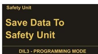
Pour sauvegarder le jeu de paramètres dans le dispositif de sécurité, sélectionnez "Save Data To Safety Unit" et confirmez par OK.
