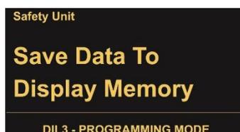
Pour sauvegarder le jeu de paramètres du dispositif de sécurité dans la mémoire flash de SMCB.1, sélectionnez "Save Data To Display Memory" et confirmez par OK.
