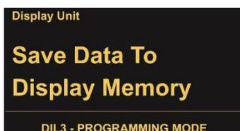
Pour sauvegarder le jeu de paramètres dans le SMCB.1, sélectionnez „Save Data To Display Memory“ et confirmez par OK.
