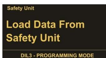
Pour charger les paramètres utilisés par le dispositif de sécurité, sélectionnez "Load Data From Safety Unit" et confirmez par OK.
