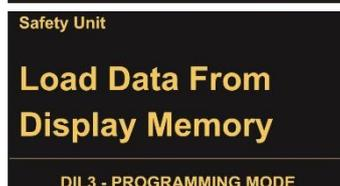
Pour charger les paramètres pour un dispositif de sécurité de la mémoire flash de SMCB.1, sélectionnez "Load Data From Display Memory" et confirmez par OK.
