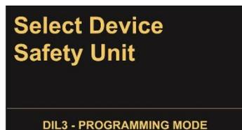
Dans le 1er niveau du menu, choisissez si les paramètres du dispositif de sécurité ou de l'unité de commande SMCB.1 devront être traités. Pour le dispositif de sécurité sélectionnez "Safety Unit" et confirmez par OK.
