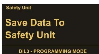
Pour enregistrer le jeu de paramètres dans le dispositif de sécurité, sélectionnez « Save Data To Safety Unit » et confirmez avec OK.
