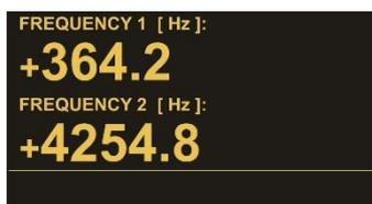
Cet écran affiche les deux fréquences d'entrée du capteur1 et capteur2 avec une décimale. (Voir « Operational Mode » du dispositif de sécurité. L'écran est indépendant de l'échelle du dispositif de sécurité.
