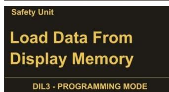
Pour charger les paramètres d'un dispositif de sécurité depuis la mémoire flash de SMCB.1, sélectionner "Load Data From Display Memory" et confirmer par OK.
