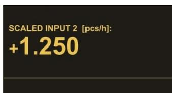
Dans cet affichage, la fréquence d'entrée de Sensor1 est convertie et affichée avec les paramètres définis du dispositif de sécurité pris du menu « OPU ». \*) Voir chapitre 0.
