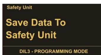
Pour sauvegarder le jeu de paramètres du dispositif de sécurité dans le dispositif de sécurité, sélectionnez "Save Data To Safety Unit" et confirmez par OK.
