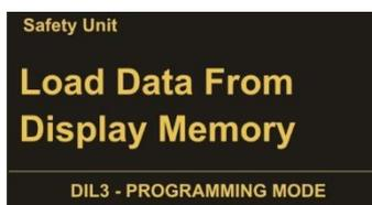
Pour charger les paramètres d'un dispositif de sécurité de la mémoire flash du SMCB.1, sélectionnez « Load Data From Display Memory » et confirmez avec OK.
