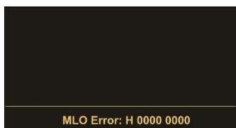
Messages d'erreur de l'appareil de sécurité sont spécifiés dans la ligne d'état de l'écran avec un nombre hexadécimal (H). Dans le manuel du dispositif de sécurité se trouve une liste de toutes les valeurs et des erreurs associées.
