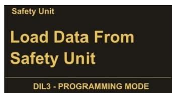
Pour charger les paramètres utilisés par le dispositif de sécurité, sélectionner "Load Data From Safety Unit" et confirmer par OK.
