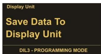
Pour sauvegarder le jeu de paramètres dans l'unité de commande SMCB.1, sélectionnez "Save Data To Display Unit" et confirmez par OK.
