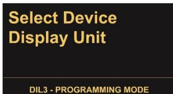
Dans le 1er niveau du menu, il est possible de choisir si les paramètres du dispositif de sécurité ou de l'unité de commande SMCB.1 doivent être traités. Pour l'unité de commande SMCB.1 sélectionnez « Display Unit » et confirmez par OK.
