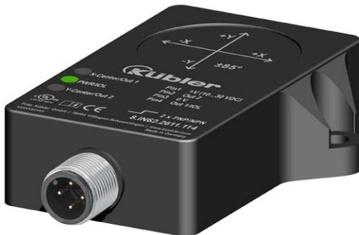
Mit den Neigungssensoren der Typenreihe IN72 werden 2-achsige Neigungen im Messbereich von  $\pm 85^\circ$  oder 1-achsige Neigungen bis  $360^\circ$  über eine Sensorfusion aus Beschleunigungs- und Drehratenmesszelle (Gyroskop) ermittelt. Für individuelle Anforderungen lassen sich unterschiedliche Parameter (z.B. über die Software PACTware) kundenspezifisch anpassen. Durch ihre hohe Robustheit sind die Neigungssensoren auch für den Einsatz im Außenbereich bestens geeignet.
